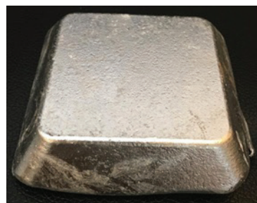
Слика 3. Алуминијум-берилијум легура \text{AlBe}_3 https://www.xingluchemical.com/bs/news/what-is-aluminum-beryllium-alloy-albe5-and-its-application/
