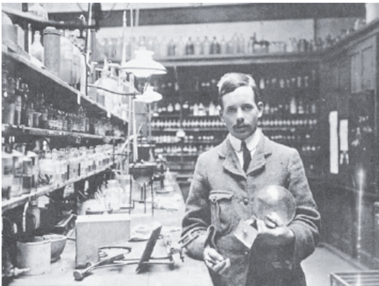
Слика 2. Хенри Мозли у својој лабораторији. У руци држи рендгенску цев помоћу које је 1913. године открио закон који данас носи његово име. Мозлијев закон омогућава да се експериментално одреди атомски број Z појединих хемијских елемената. Две године касније, Мозли је погинуо у Првом светском рату.
