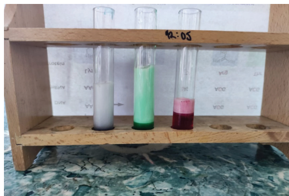
Слика 20. Резултат испитивања активности каталазе на различитим рН вредностима (лево, „плава“ епрувета; средина, „зелена“ епрувета; десно, „црвена“ епрувета).
