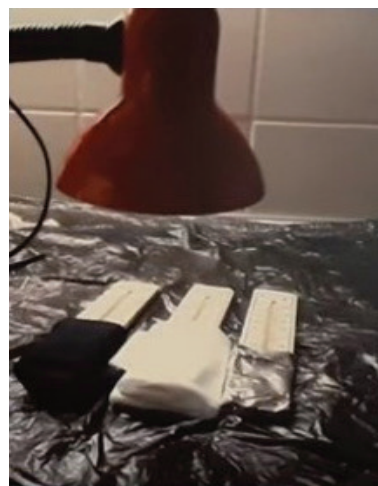
Слика 11. Експеримент о утицају боје на температуру неког објекта (модел воде, снега, леда). Термометри су обавијени истим материјалом у различитим бојама.
