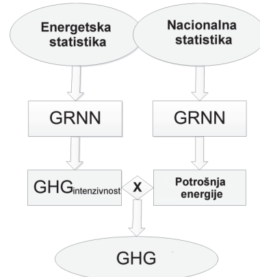
Слика 7. Предвиђање GHG емисија на основу концепта GHG интензивности
